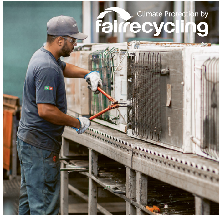
Ein Mitarbeiter entfernt in der Fabrik in Brasilien den Kompressor. Das FCKW wurde vorgängig abgezogen und im Hochtemperaturofen vollständig verbrannt. Pro Kühlschrank können so Treibhausgasemissionen im Umfang von einer Tonne CO 2 -Äquivalenten vermieden werden.
